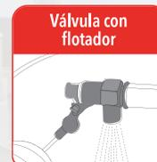
Instalar una válvula con flotador sobre la perforación alta.
