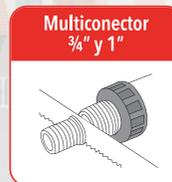
Conectar la tubería de salida en el multiconector.
